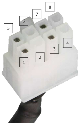
Ilustr. 3: Wtyczka Molex, rozmieszczenie pinów
